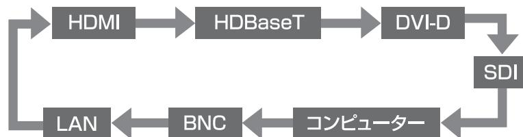
複数の機器を接続しているときは、目的の映像が投写されるまで【入力検出】ボタンを繰り返し押します。
