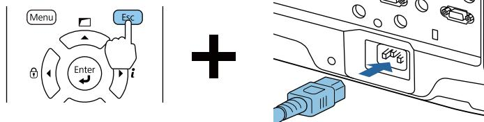
プロジェクターのインジケーターが以下のように点灯したら、【戻る】ボタンを離してください。
