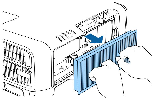
**4 エアフィルターの表側(取り出し用のツマミのある面)を下にして、4~5回たたいてホコリを落とします。**
