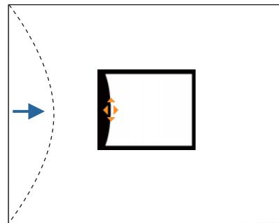
補正中に以下の画面が表示されたときは、グレーの三角で示す部分が補正量の限界に達したことを示しています。
