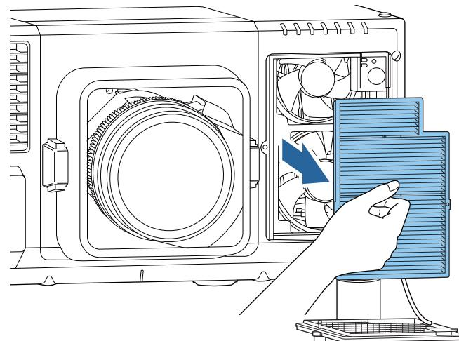
**4** エアフィルターの表側(取り出し用のツマミのある面)を下にして、4~5回たたいてホコリを落とします。
