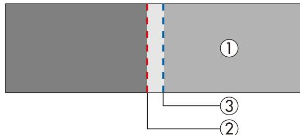
上図①では、投写映像の左側が重なり合うので、[エッジ位置(左)]を調整します。
