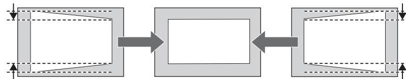
映像のアスペクトが崩れたときは、[タテバランス]と[ヨコバランス]で映像のバランスを調整します。
