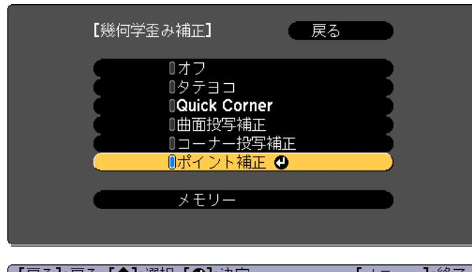
「補正方法が変更されます。画面の形状が大きく変わることがあります。」と表示されたときは、もう一度【↔】ボタンを押します。
