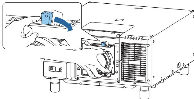
**7** より確実にレバーを固定するには、レバーロックでレバーを固定します。
