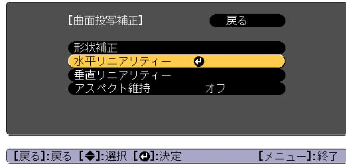
左右方向の伸縮を補正する場合は【水平リニアリティ】、上下方向の伸縮を補正する場合は、【垂直リニアリティ】を選択します。
