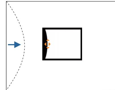
補正中に以下の画面が表示されたときは、グレーの三角で示す部分が補正量の限界に達したことを示しています。
