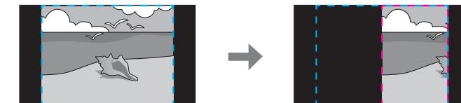
[フル表示]：プロジェクターのパネルサイズ(映像を表示できる最大領域)を基準にして調整します。
