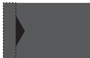
調整後、色合いが同じにならない箇所は【エリア補正】で調整します。
