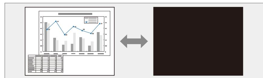
【A/Vミュート】ボタンを押すたびにA/Vミュートが実行/解除されます。
