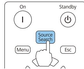
複数の機器を接続しているときは、目的の映像が投写されるまで【入力検出】ボタンを繰り返し押します。
