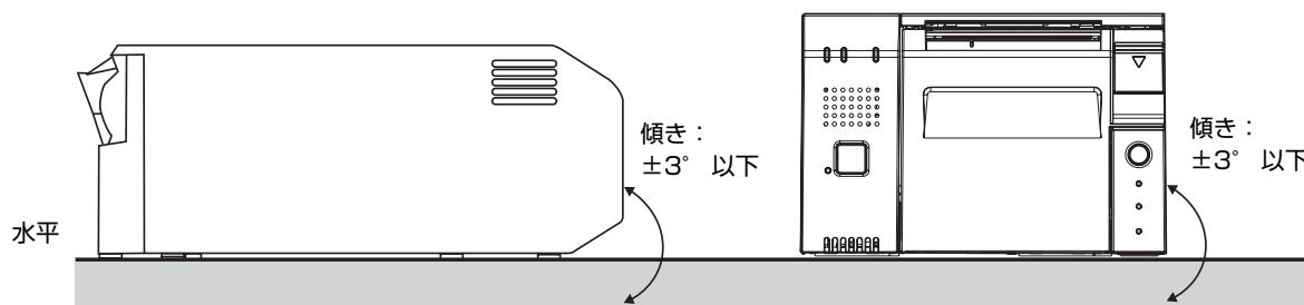
本製品を棚などの周りが囲まれた空間に設置する場合、棚の内部に熱がこもらないよう以下の隙間を確保してください。
