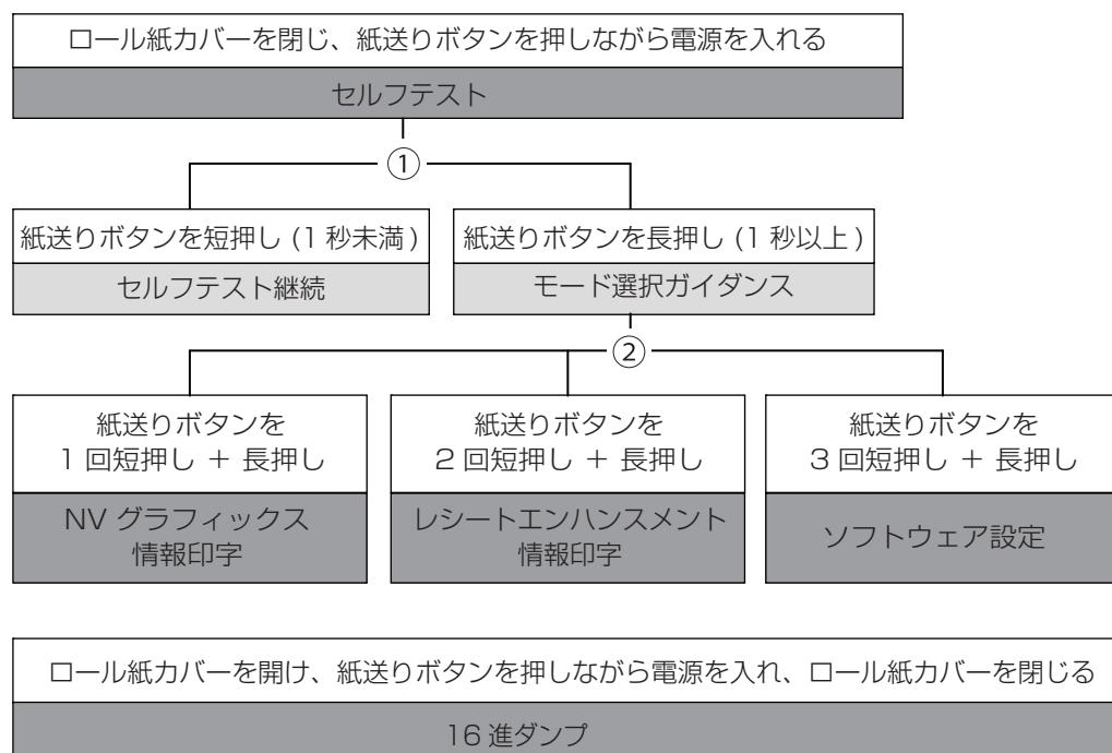
図中①、②では以下のガイダンスが印字され、Paper LED が点滅してユーザー操作を促します。
