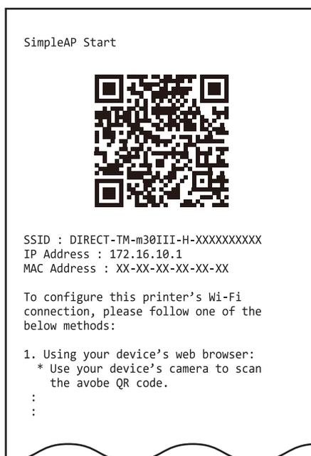
オプションの無線 LAN ユニットをご使用の場合でも、プリンターの電源を入れたときに SimpleAP が自動起動すると、上記と同じ「SimpleAP Start」シートが印刷されます。
