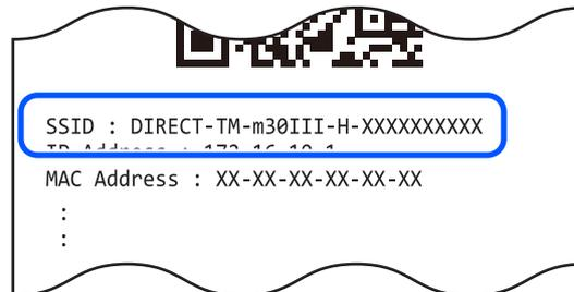
プリンターと接続されると、Web Config にアクセスするためのガイダンスが印刷されます。
