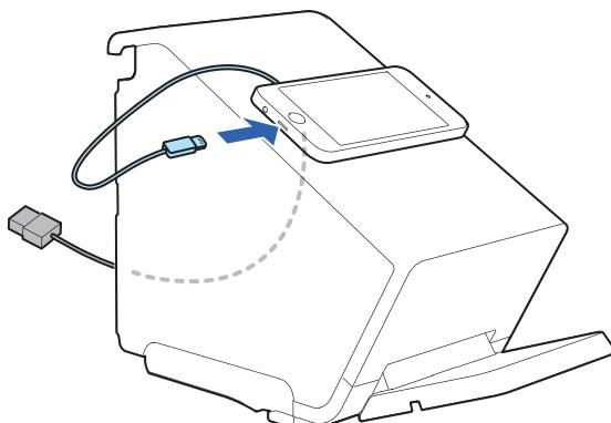
**10** 引き出すケーブルの長さを調整します。接続ケーブルが強く曲がらないように余裕を持たせます。
