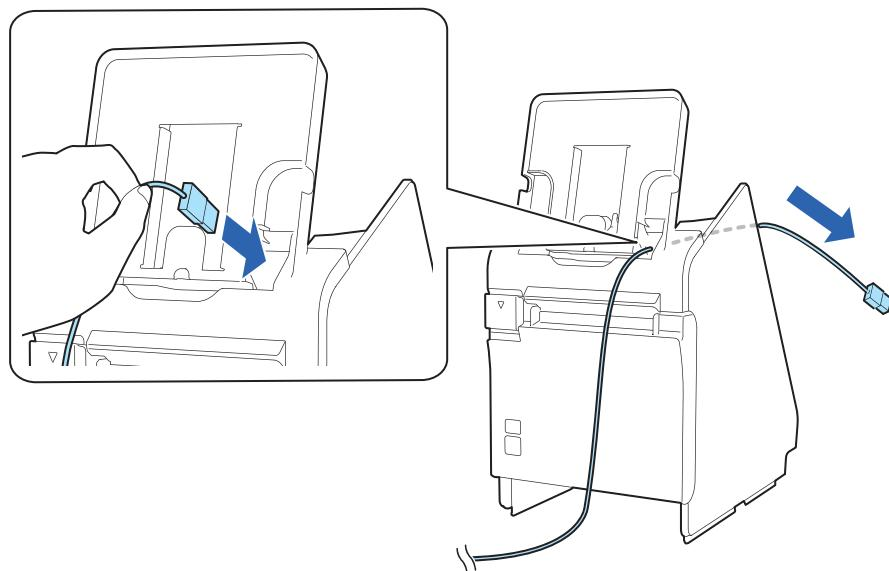
7 タブレットに接続ケーブルを接続します。
