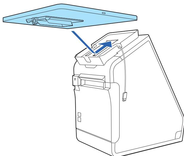
**3** 同梱の手回しネジまたはネジで固定します。
