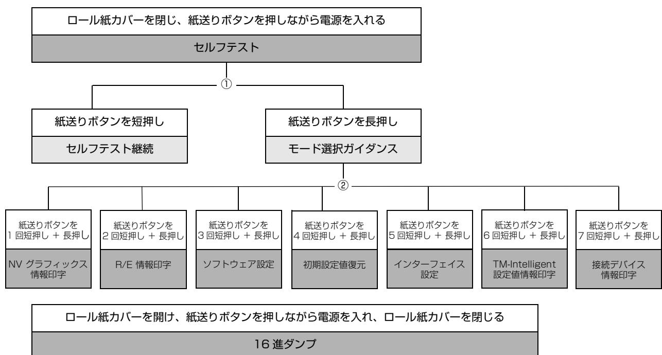
①、②では以下のガイダンスが印字され、ペーパーLEDが点滅してユーザー操作を促します。
