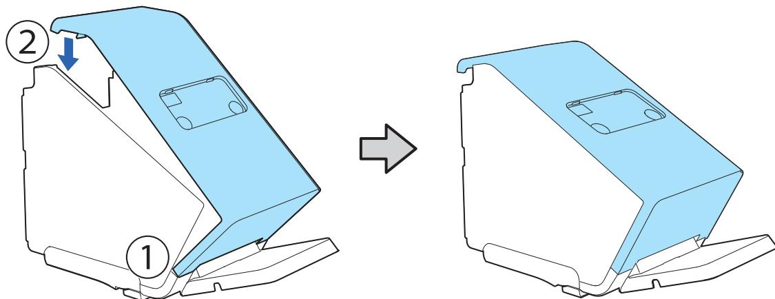
**15** ネジ2本で固定します。
