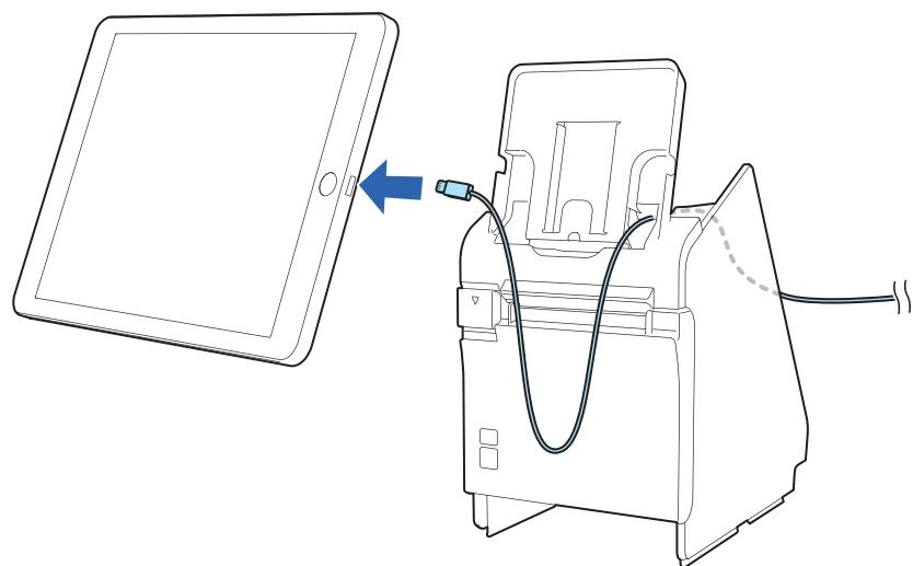
8 タブレットを手で支えながら引き出すケーブルの長さを調整します。接続ケーブルが強く曲がらないよう余裕を持たせます。
