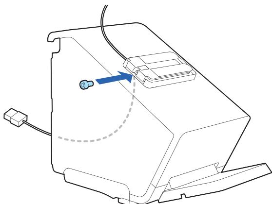
**6** アタッチメントの上に DM-D70 を置いて、貼り付け位置を確認します。
