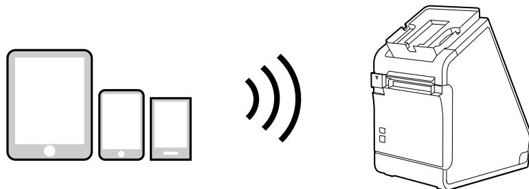
無線 LAN の接続設定が初期値（工場出荷状態）の場合、プリンターの電源を入れると自動的に SimpleAP モードで起動し、下図の印字を行います。無線 LAN の接続設定が初期値から変更されている場合は、その設定に従って起動し、アクセスポイントへ接続します。
