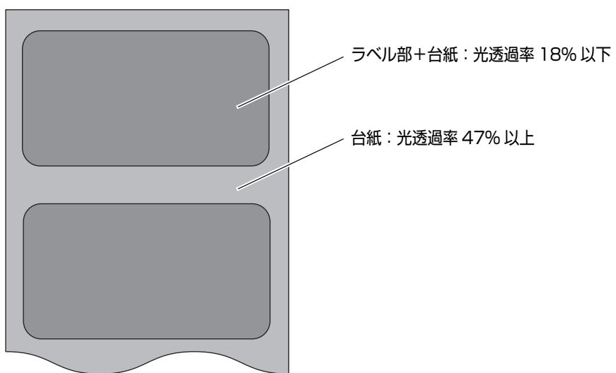
注) 光透過率の測定はマクベス濃度計 TD-904 を使用。
