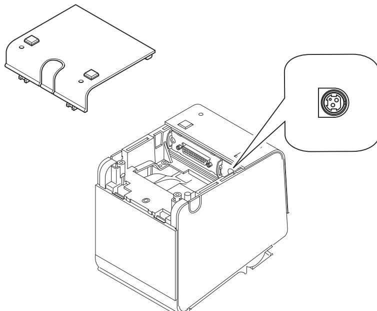
**4** 背面カバーの通線用ノックアウト(3箇所)のいずれかを切り取り、ケーブルを通します。
