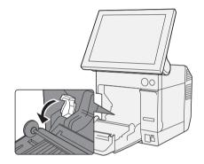
6 印刷面が上になるように少し引き出して、ロール紙を奥まで挿入します。
