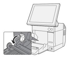
▲ 印刷面が上になるように少し引き出して、ロール紙を奥まで挿入します。
