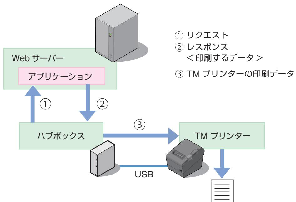
サーバーダイレクトプリント対応プリンター／ハブボックスは、定期的に Web サーバーに印刷要求リクエスト（上図①）を送ります。
