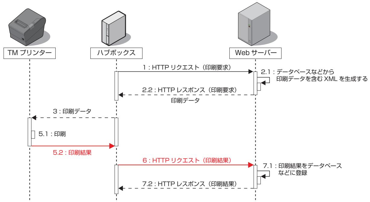
アプリケーションは、HTTP リクエスト（印刷結果）を解析して、印刷結果（正常に印刷できたか）や、プリンターの状態を確認できます。
