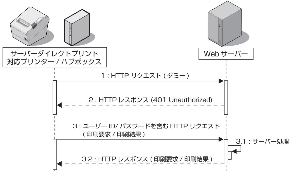
Digest認証の場合、サーバーに印刷関連のリクエストを送る前に、HTTPリクエスト(ダミー)を送ります。サーバーからHTTPステータスコード"401 Unauthorized"のレスポンスが返されます。ユーザーIDとパスワードが含まれた、印刷関連のリクエストを送ります。サーバーではDigest認証の処理が行われます。Digest認証されると、続けて印刷関連の処理が行われます。通信に失敗した場合、指定の間隔を空けてから再度通信を試みます。
