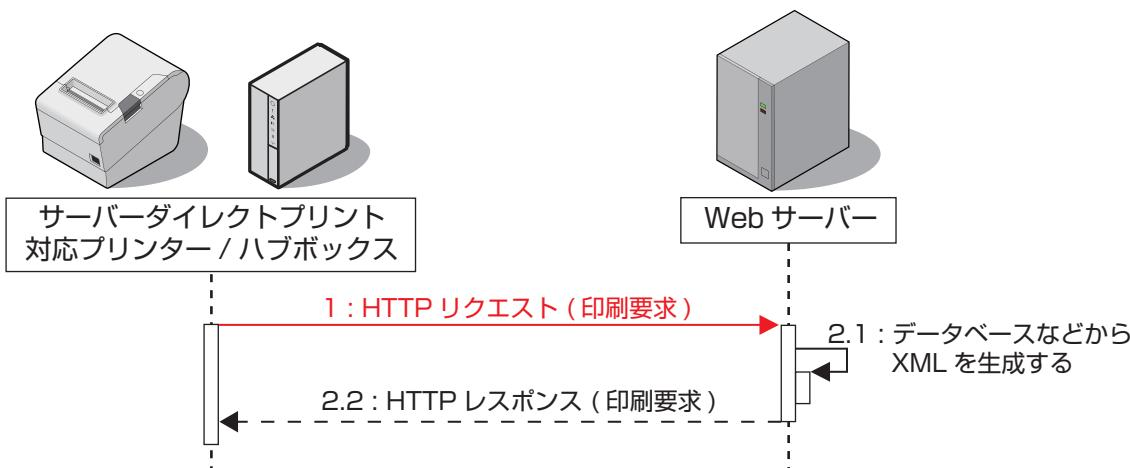
サーバーダイレクトプリント対応プリンター / ハブボックスは、以下の HTTP POST リクエスト（印刷要求）を定期的に送ります。
