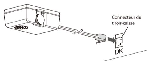
5. Retirez la pellicule de l'autre côté de l'adhésif de fixation puis fixez l'alarme sonore externe en option sur le boîtier de l'imprimante.
