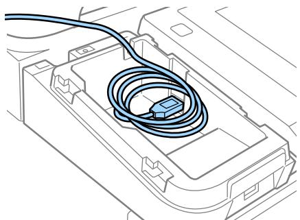
6. カバーを取り付けます。カバーがネジで固定されていた場合、ネジで固定します。
