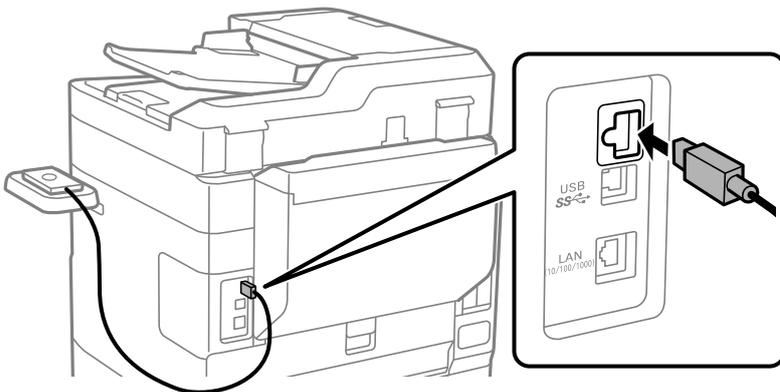
10. 以下のようにシールを剥して、プリンター本体に付属のクランプを差し込み、ケーブルを配線します。
