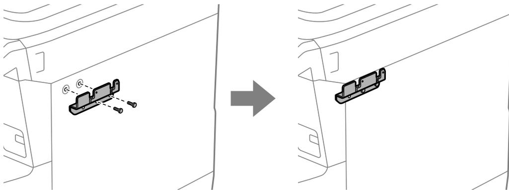
3. 認証デバイス台の部品 (b) の突起部が金属板 (g) の穴に入るようにまっすぐ差し込みます。
