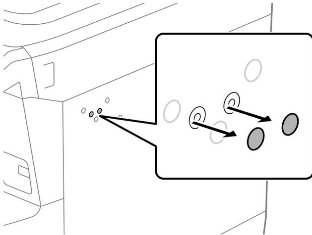
2. プラスドライバーを使って、金属板(g)をネジ(e)2本で固定します。
