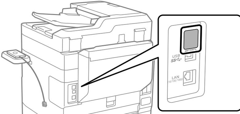
9. 認証装置のケーブルをサービス用ポートに接続します。
