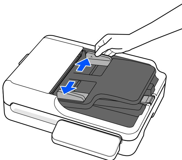
2. 原稿のスキャンする面を上にして、先端をADFに向けてまっすぐにセットします。
