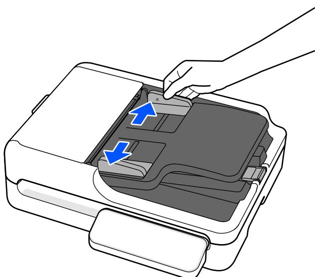
2. 原稿のスキャンする面を上にして、幅の広い原稿から順に重ねて、給紙トレイの中央にセットします。
