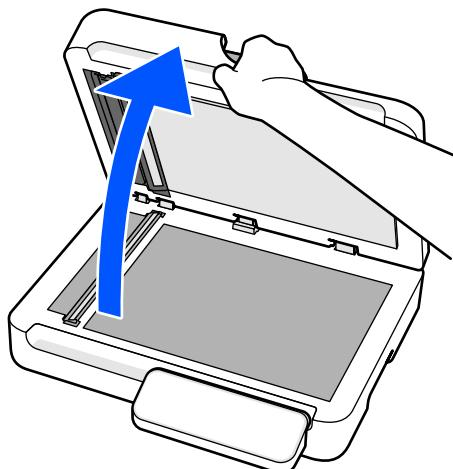
2. 表面を読み取ります。読み取る面を下にして、原稿台の角（原点マーク側）から6 mm以上離して原稿を置きます。
