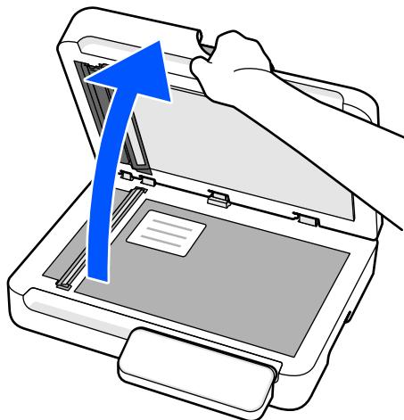
6. 裏面を読み取ります。読み取る面を下にして、原稿台の角（原点マーク側）から6 mm以上離して原稿を置きます。
