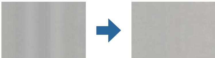
直射日光などの強い光に当たる場所でスキャナーを使用すると、内部のセンサーが光を誤検知して、スキャンした画像に濃淡のムラが出ることがあります。
