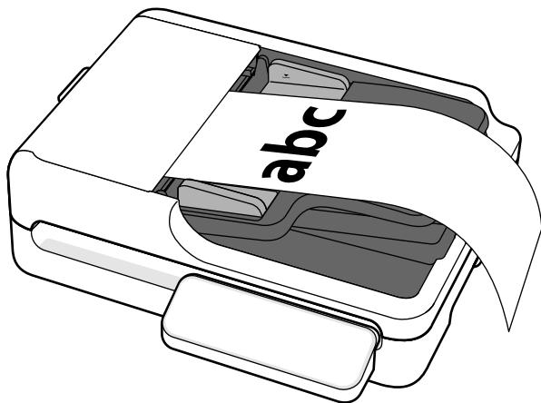
3. 原稿ガイドを、原稿に隙間なく合わせます。隙間があると原稿が斜めに給紙されることがあります。
