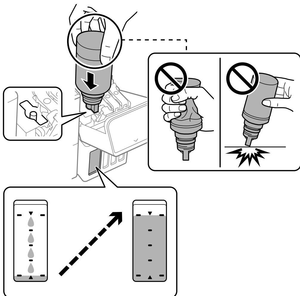
9. インクの注入が完了したらボトルを抜いて、インクボトルのキャップを確実に締めます。
