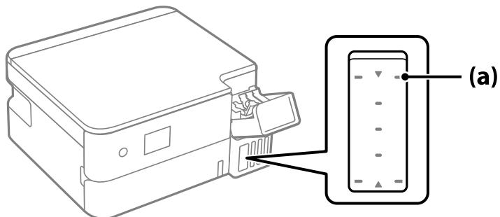
8. インクの注入口に合わせてボトルを挿し、インクが上限線の位置に自動で止まるまで待ちます。
