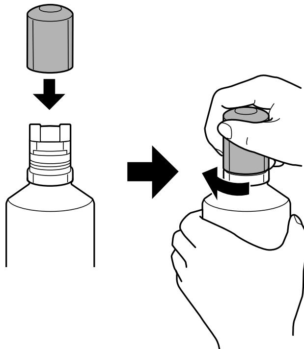
10. インクタンクキャップを確実に閉めます。
