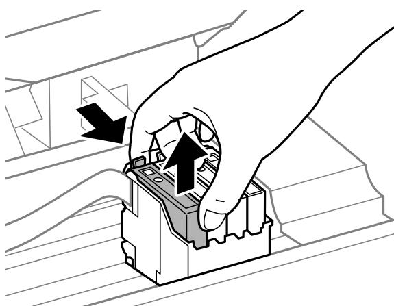
6. 新しいインクカートリッジを挿入して、[押] の部分をしっかりと押し込みます。
