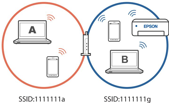
このような状態にならないために、2台目のコンピューターからネットワーク設定済みのプリンターをセットアップしたい場合は、コンピューターをプリンターと同じネットワークに接続した状態でインストーラーを起動してください。同じネットワーク内にプリンターが見つかると、プリンターのネットワーク再設定は行われず、コンピューターからプリンターを使える状態にセットアップされます。
