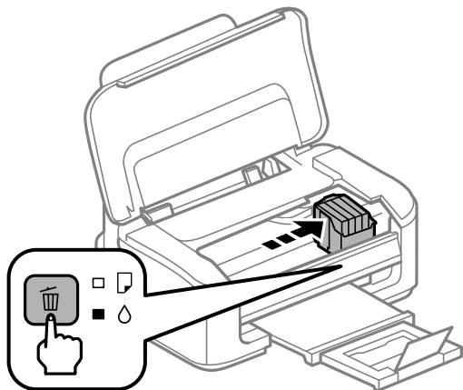
4. インクカートリッジを交換するときは、新しいインクカートリッジを4~5回振った後、袋から出します。
