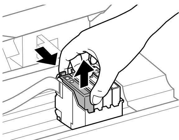
7. 新しいインクカートリッジを挿入して、[押] の部分をしっかりと押し込みます。
