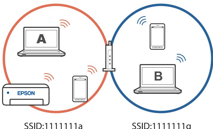
さらに、上記の状態でコンピューターBからプリンターのセットアップを開始すると、同じネットワーク内にプリンターが見つからないので、コンピューターBのネットワーク上にプリンターがセットアップされます。コンピューターBからは印刷が可能になりますが、コンピューターAからは印刷できなくなります。
