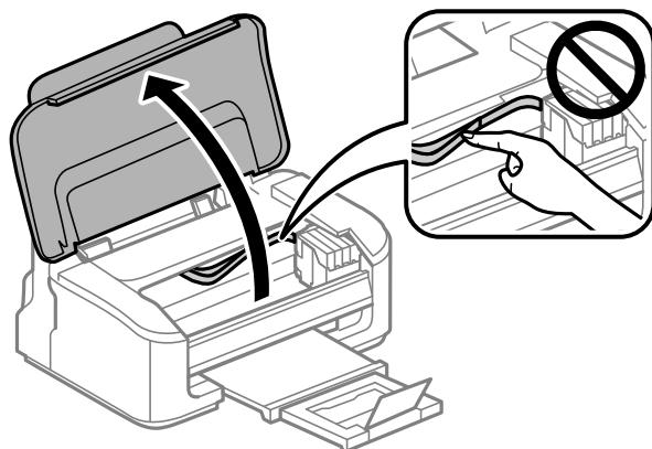
2. 以下のボタン操作でインクカートリッジ挿入部を移動させます。
