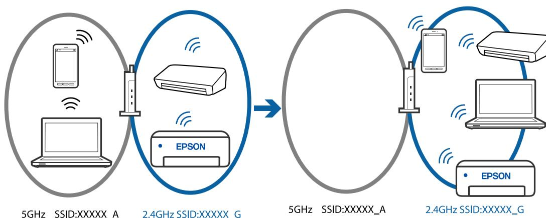
コンピューターやスマートデバイスと同じSSIDに接続してください。
