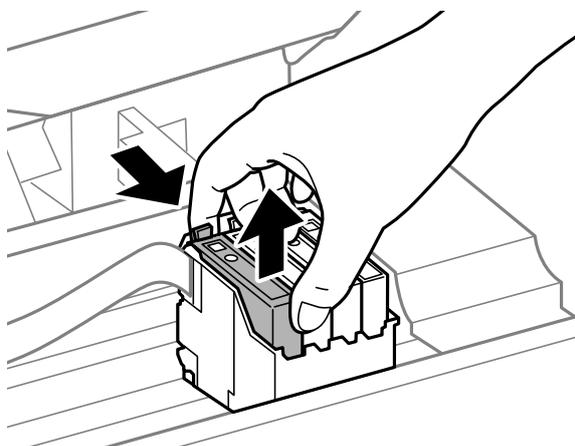
7. 新しいインクカートリッジを挿入して、[押]の部分をしっかり押し込みます。
