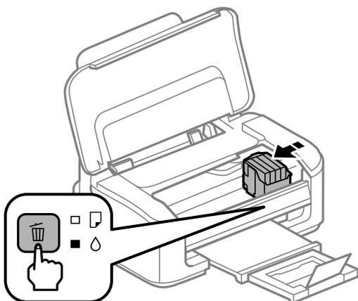
インクカートリッジ挿入部がカートリッジ交換位置に移動します。
