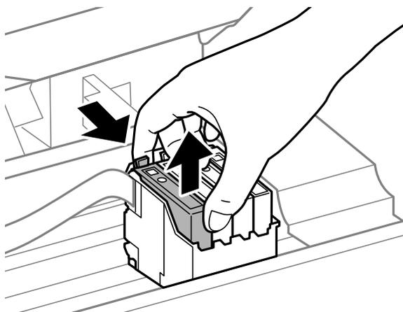
6. 新しいインクカートリッジを挿入して、[押]の部分をしっかり押し込みます。
