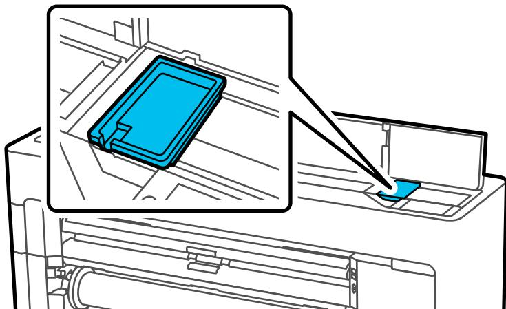
3. サービス用ポートに認証装置のUSBケーブルを接続します。
