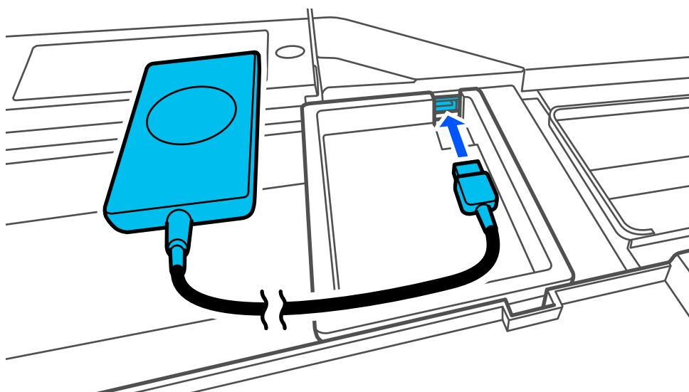
**△注意** 認証デバイス台の取り外しが必要な場合、認証装置のケーブルを外してから認証デバイス台を取り外してください。
