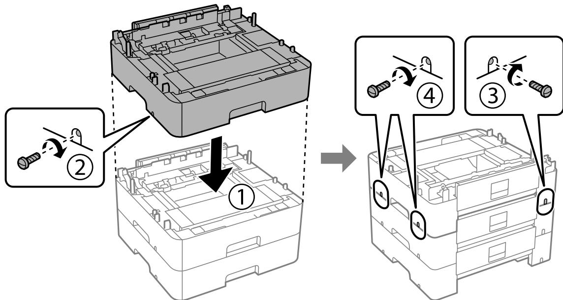
11. プリンターを、増設カセットユニットの四隅と合わせながらゆっくり下ろして置き、ドライバーを使ってネジで固定します。
