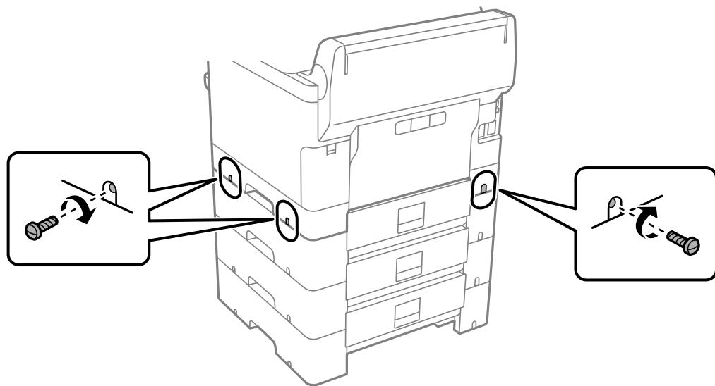
13. 手順4で取り外したパーツを、一番下の増設カセットユニットの背面に取り付けます。
