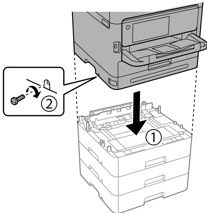
12. プリンターの向きを変えて、増設カセットユニットとプリンターの背面および右側を、ドライバーを使ってネジで固定します。
