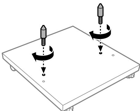
5. 一番下の増設カセットユニットをプリンタ一台にセットします。この時、増設カセットユニットの底部の穴をガイドピン(a)に合わせます。
