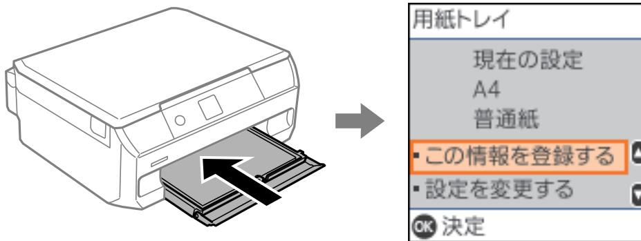
表示された用紙サイズや種類がセットした用紙と異なる場合は、[設定を変更する] を選択して変更してください。用紙サイズと用紙種類を選択し、設定を確認してOKボタンを押します。このままでいい場合は [この情報を登録する] を選択してください。
