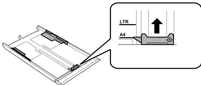
6. 印刷する面を下にして、手前の用紙ガイドに合わせてセットします。
