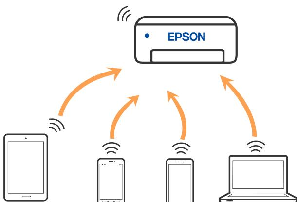
プリンターは無線LAN（Wi-Fi）とWi-Fi Direct（シンプルAP）の同時接続ができます。ただし、無線LAN（Wi-Fi）で接続中にWi-Fi Direct（シンプルAP）設定を開始すると、無線LAN（Wi-Fi）接続は一時切断されます。
