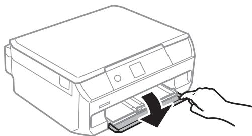
3. プリンターが動作していないことを確認して、用紙トレイを引き抜きます。
