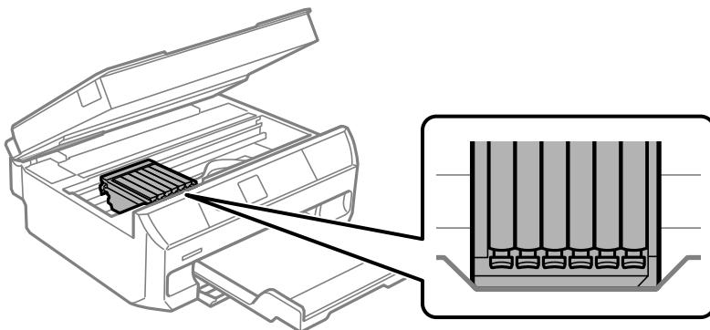
7. ツメを押してインクカートリッジを外し、斜めに引き上げて取り出します。
