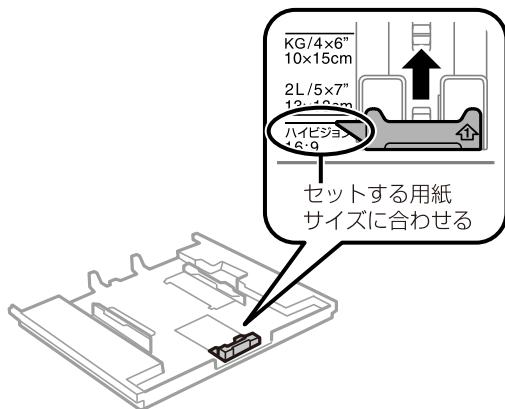
7. 印刷する面を下にして、手前の用紙ガイドに合わせてセットします。
