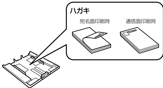
下トレイにセットするときは、印刷する面を下にして、手前の用紙ガイドに合わせてセットします。その後用紙ガイドをハガキの側面に合わせてください。
