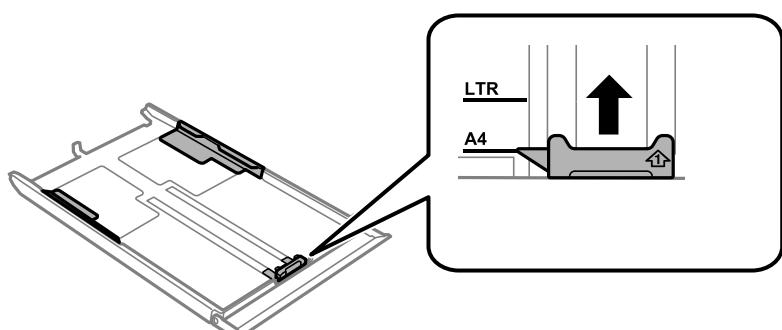
7. 印刷する面を下にして、手前の用紙ガイドに合わせてセットします。
