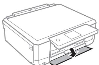
4. プリンターが動作していないことを確認して、上トレイを引き抜きます。上トレイには目印 ➤ が付いています。
