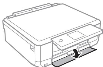
4. プリンターが動作していないことを確認して、下トレイを引き抜きます。
