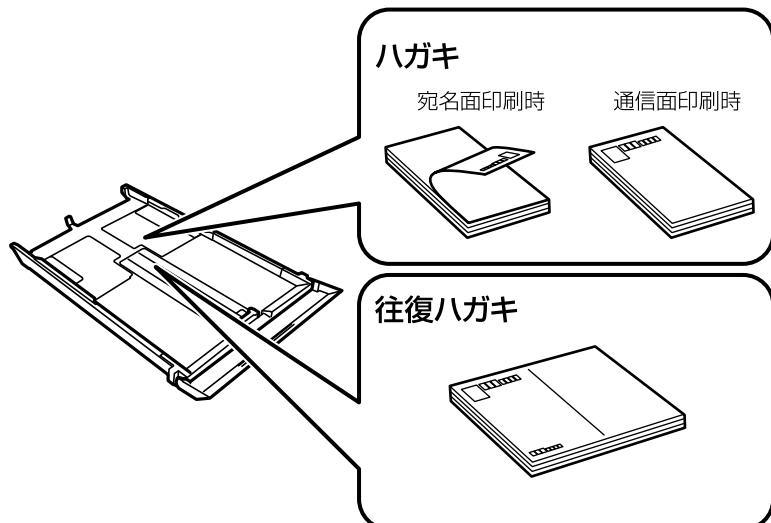
手差し給紙にセットするときは、印刷する面を手前にして中央にセットし、用紙ガイドをハガキの側面に合わせてください。
