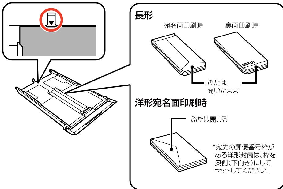
手差し給紙にセットするときは、印刷する面を手前にして中央にセットし、用紙ガイドを封筒の側面に合わせてください。
