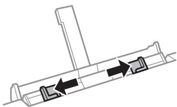
7. 印刷する面を手前にして、手差し給紙の中央に用紙の先端を約5cm差し込みます。
