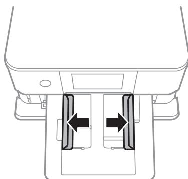
5. 印刷する面を下にして、上トレイの奥に突き当てるでセットします。
