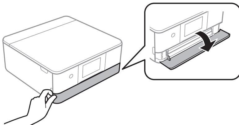
3. プリンターが動作していないことを確認して、下トレイを引き出します。
