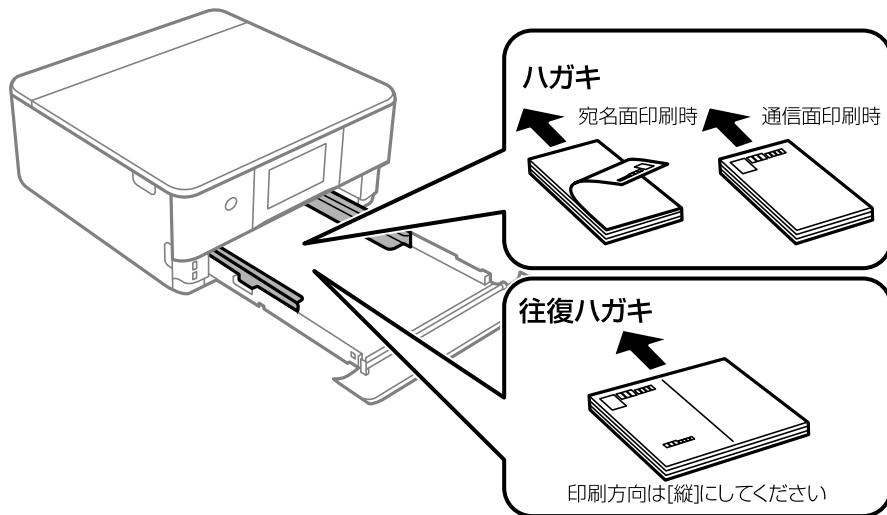
手差し給紙にセットするときは、印刷する面を手前にして中央にセットし、用紙ガイドをハガキの側面に合わせてください。
