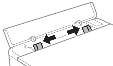
3. 印刷する面を手前にして、手差し給紙の中央の矢印マークに合わせてセットします。
