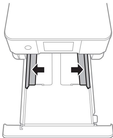
5. 印刷する面を下にして、下トレイの奥に突き当ててセットします。
