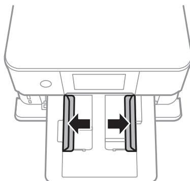
5. 印刷する面を下にして、上トレイの奥に突き当ててセットします。
