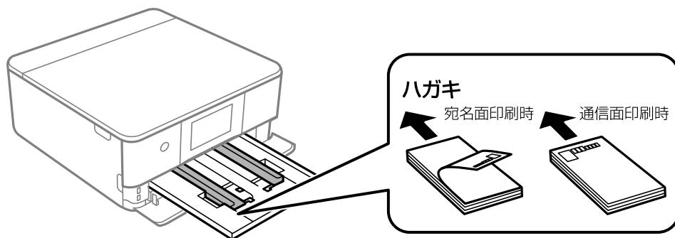
下トレイにセットするときは、印刷する面を下にして、図の矢印の向きで下トレイの奥に突き当てるでセットします。その後用紙ガイドをハガキの側面に合わせてください。
