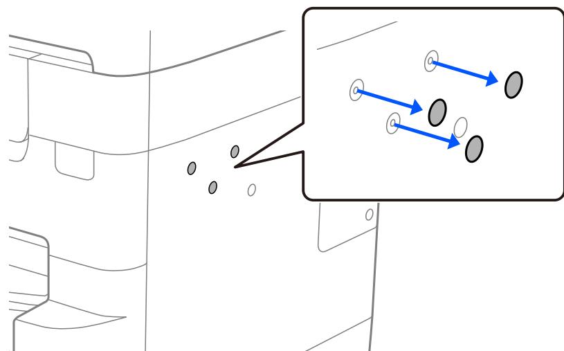
2. コインやドライバーを使って、土台をネジで固定します。
