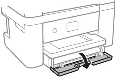
2. プリンターが動作していないことを確認して、用紙カセットを引き出します。
