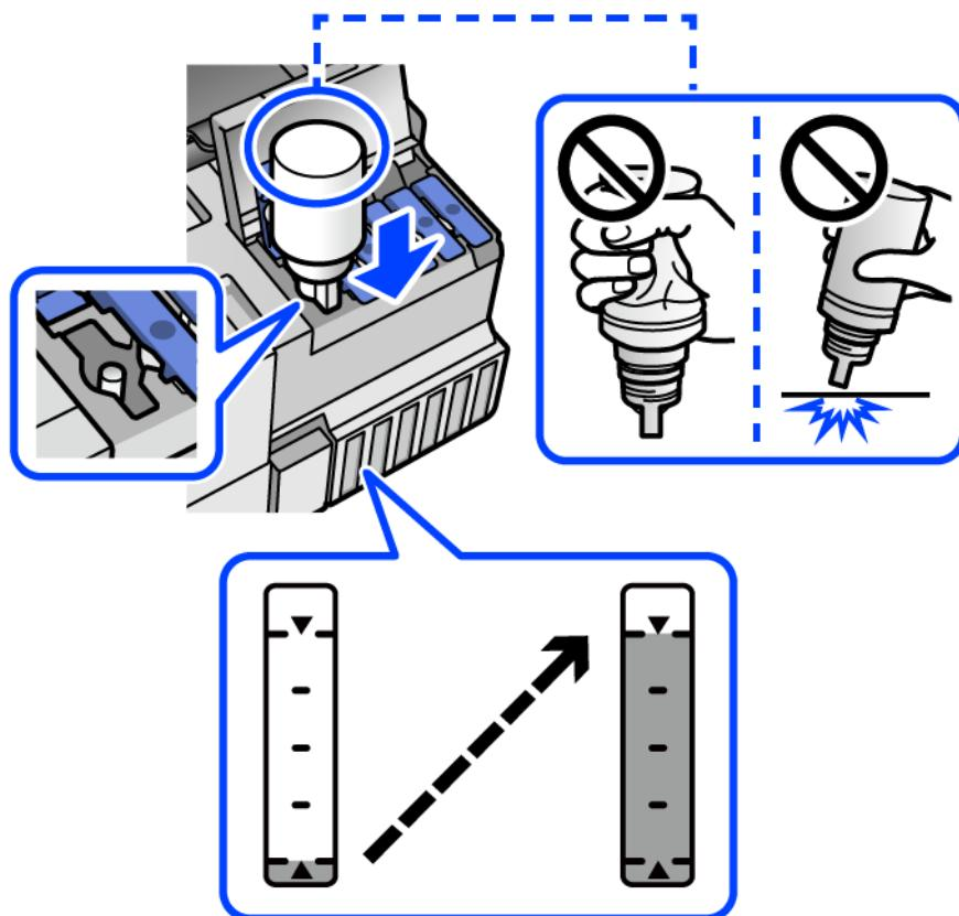
8. インクの注入が完了したらボトルを抜いて、インクボトルのキャップを確実に締めます。
