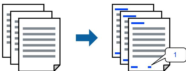
1. プリンタードライバーの [応用設定] タブで [セキュリティ設定] をクリックして、[ヘッダー/フッター] にチェックします。
