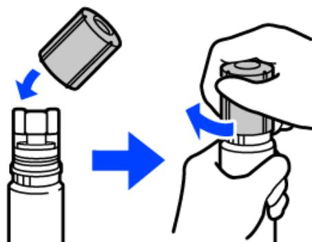
9. インクタンクキャップを確実に閉めます。
