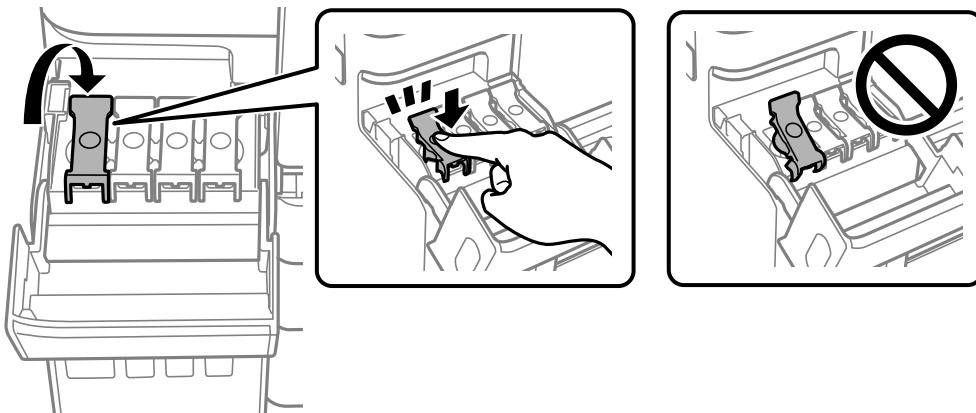
**!重要** ボトルをタンクに挿したままにしないでください。ボトルの破損やインク漏れの原因になることがあります。
