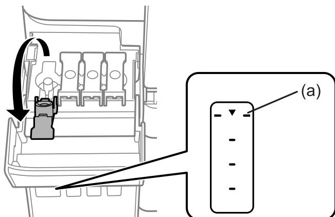
8. インクの注入口に合わせてボトルを挿し、インクが上限線で自動で止まるまで待ちます。
