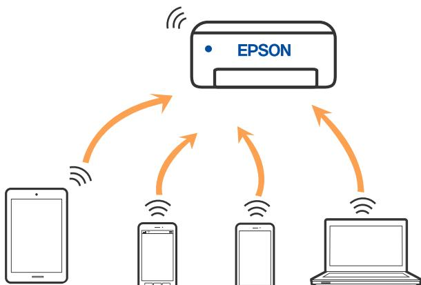
プリンターは無線LAN（Wi-Fi）または有線LANと、Wi-Fi Direct（シンプルAP）の同時接続ができます。ただし、無線LAN（Wi-Fi）で接続中にWi-Fi Direct（シンプルAP）設定を開始すると、無線LAN（Wi-Fi）接続は一時切断されます。
