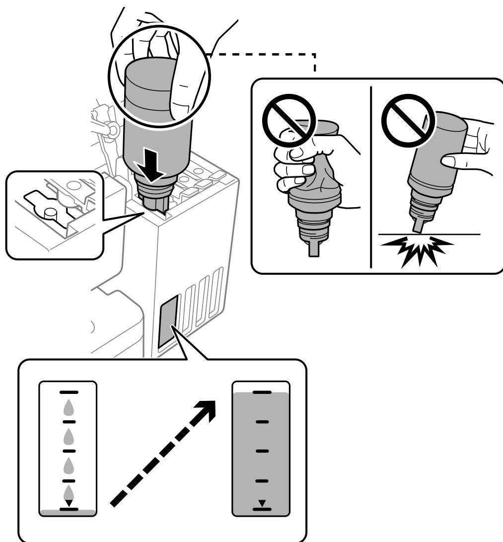
8. インクの注入が完了したらボトルを抜いて、インクボトルのキャップを確実に締めます。
