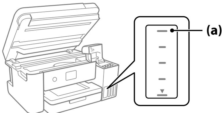
7. インクの注入口に合わせてボトルを挿し、インクが上限線で自動で止まるまで待ちます。
