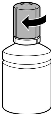
9. インクタンクキャップを確実に閉めます。
