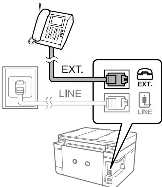
**参考** 1つの電話回線で、ファクスと電話の両方を使用するときは、必ず外付け電話機をプリンターのEXT.ポートに接続してください。同回線にプリンターと並列で接続すると（ブランチ接続）、プリンターも電話機も正常な動作ができなくなります。
