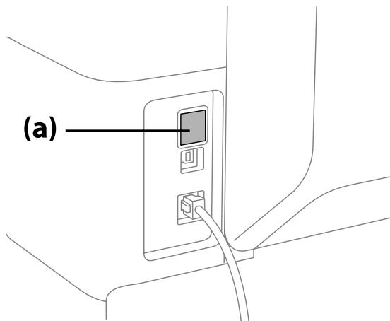
2. 認証装置のUSBケーブルをサービス用ポートに差し込みます。
