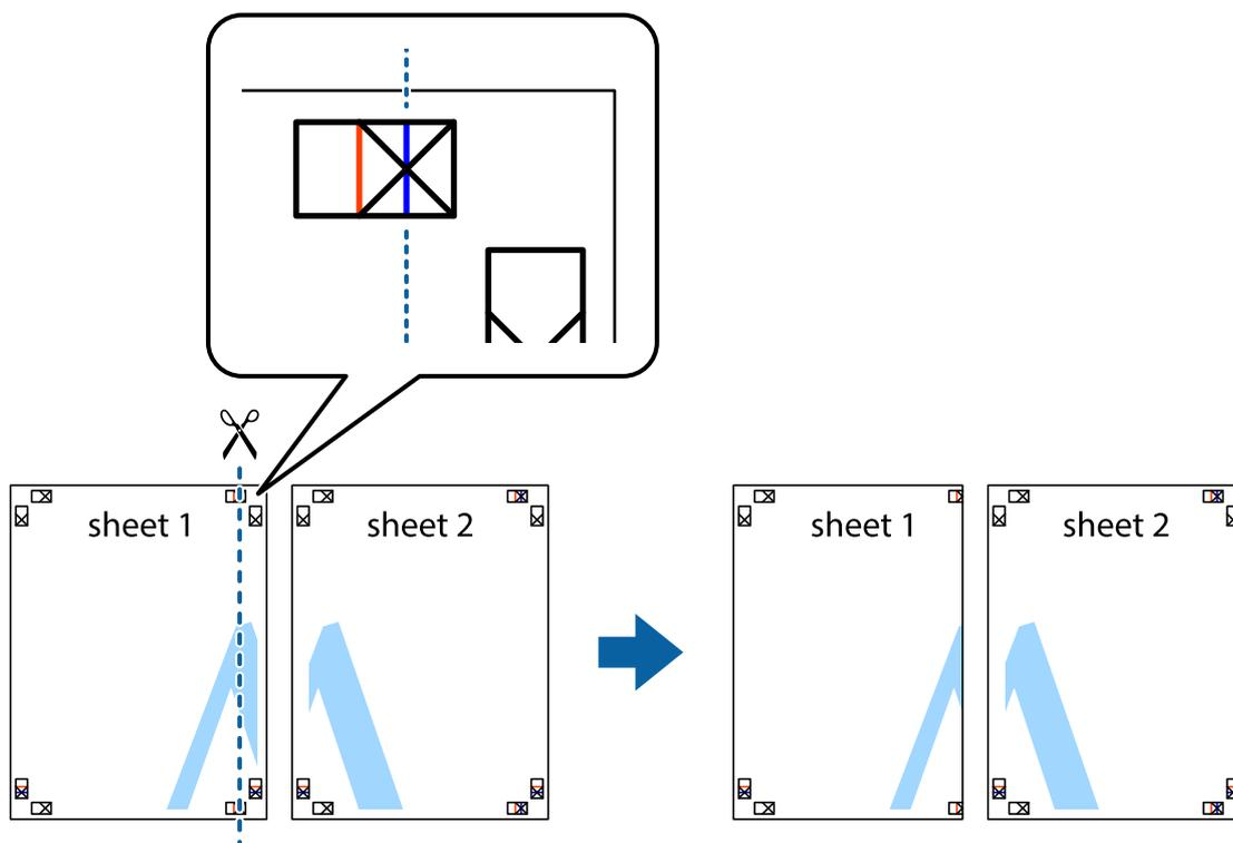
2. Sheet 1をSheet 2の上に重ね、×印が合うようにして、裏面にテープを貼って仮留めします。
