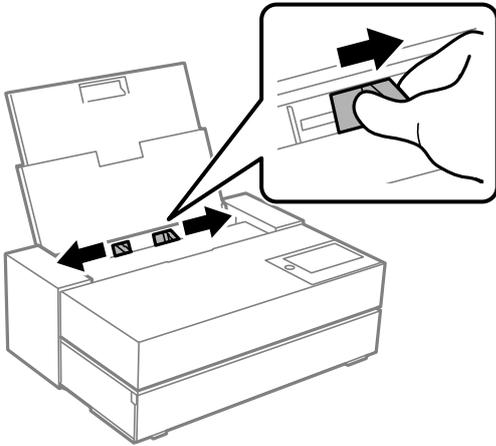
3. 印刷する面を手前にして、縦長に用紙をセットします。
