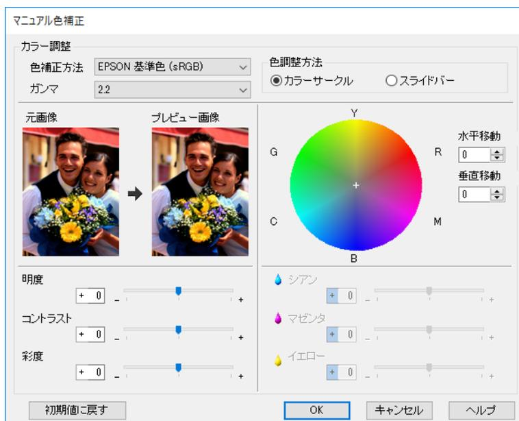
**参考** 画面左側のサンプル画像で確認しながら補正值の調整ができます。また、カラーサークルを使用すれば、カラーバランスの微調整ができます。
