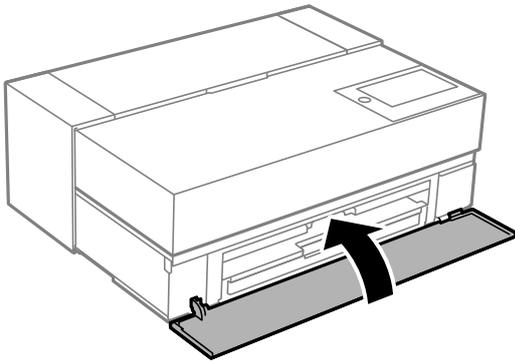
**！重要** 印刷後は必ずディスクトレイを取り出してください。プリンターにセットした状態で、電源の「入」「切」や、プリントヘッドのクリーニングなどをすると、プリントヘッドとトレイ先端が接触して故障するおそれがあります。
