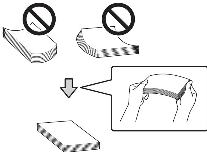
ハガキの反りを直しても正常に給紙できないときは、プリンターにセットするハガキの枚数を減らして再度試してください。
