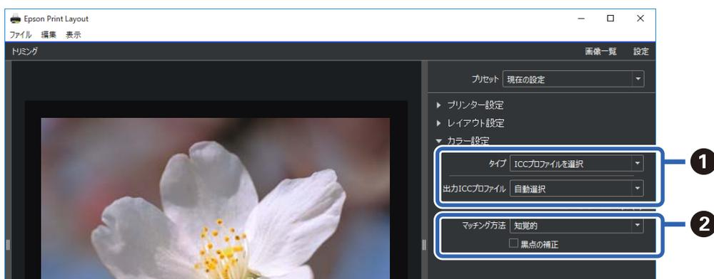
① [タイプ] で [ICCプロファイルを選択] を選択します。[出力ICCプロファイル] で [自動選択] を選択すると、手順2で選択した用紙のICCプロファイルが自動で設定されます。
