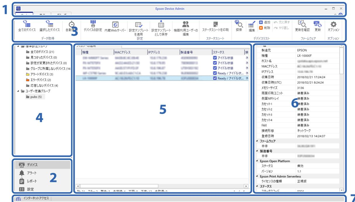
Epson Device Adminのトップ画面は以下のペインで構成されています。トップ画面はサイドバータスクメニューで選択されている項目に応じて表示が切り替わります。
