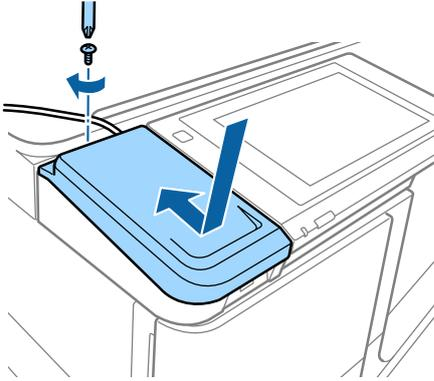
7. 認証装置をカバーの上に置き、必要に応じて両面テープなどで固定します。
