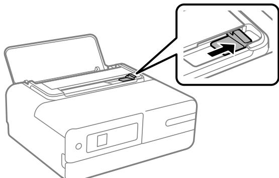
3. 読み取る面を下にして、原稿給紙口の左端に合わせて1枚の原稿をセットします。
