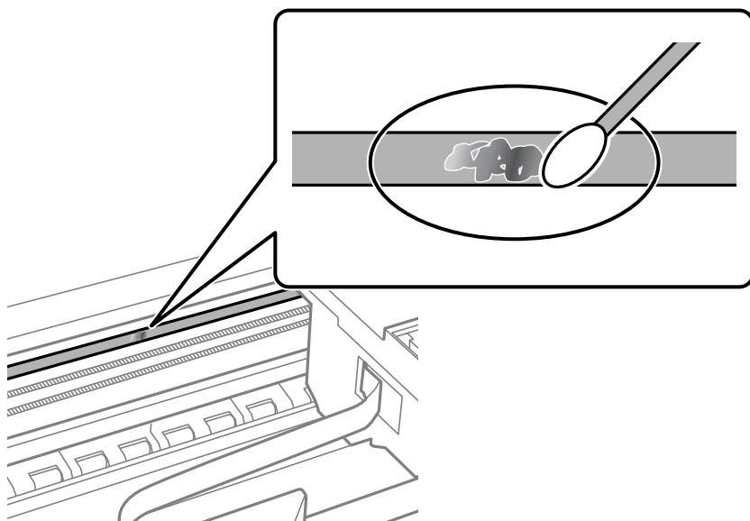
**！重要** 汚れは優しく拭き取ってください。綿棒を強く押し付けると、フィルムの固定バネが外れて、プリンターが故障
