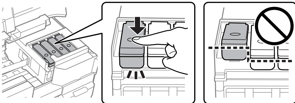
**!重要** 電源を切ってもインクタンクがホームポジションに戻らない場合は、インクタンクを手で押して移動してください。インクが漏れるおそれがあります。
