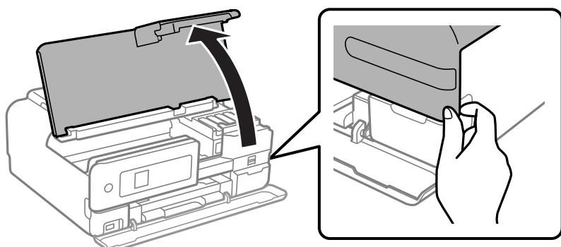
4. ツメを押して、メンテナンスボックスカバーを取り外します。
