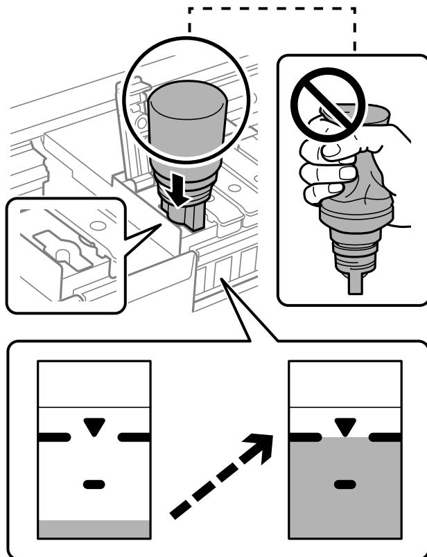
**!重要** キャップを外したボトルの先端をぶつけないでください。インクが漏れることができます。
