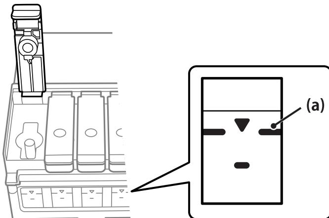
8. インクの注入口に合わせてボトルを挿し、タンクの上限線まで注入します。
