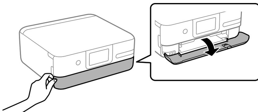
3. プリンターが動作していないことを確認して、用紙トレイを引き出します。
