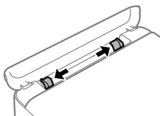
5. 印刷する面を手前にして、手差し給紙の中央にセットします。
