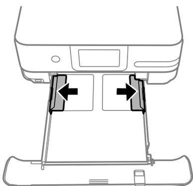
5. 印刷する面を下にして、用紙トレイの奥に突き当ててセットします。
