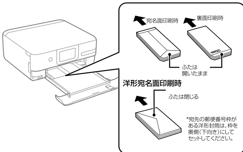
手差し給紙にセットするときは、印刷する面を手前にして中央にセットし、用紙ガイドを封筒の側面に合わせてください。
