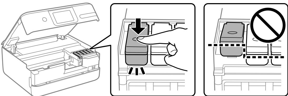
**！重要** 電源を切ってもインクタンクがホームポジションに戻らない場合は、インクタンクを手で押して移動してください。インクが漏れるおそれがあります。
