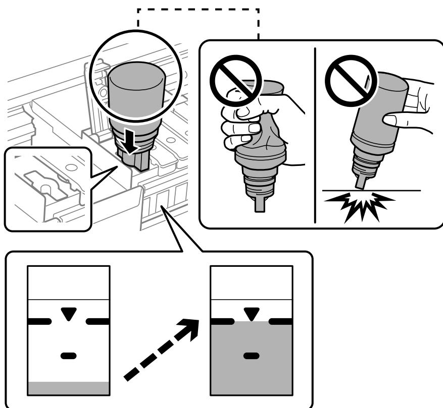
9. インクの注入が完了したらボトルを抜いて、インクボトルのキャップを確実に締めます。
