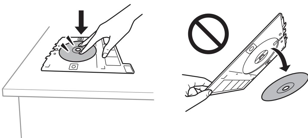
11. ディスクトレイ挿入部(排紙トレイの上の隙間)に、ディスクトレイを挿入します。プリンターの「EPSON」の下に、ディスクトレイの線を合わせてください。
