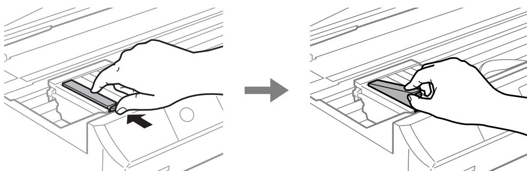
8. 新しいインクカートリッジを先端側から斜めに挿入し、[押] の部分をゆっくり押します。正しく挿入されると「カチッ」と音がします。
