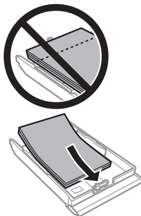
長形封筒をセットするときは、トレイ先端の三角マークに合わせてセットし、左右と手前の用紙ガイドを合わせます。
