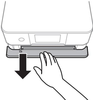
**参考** 下トレイは完全に引き抜かなくても封筒をセットできます。下トレイを取り外すには、少し上に持ち上げながら引き抜いてください。
