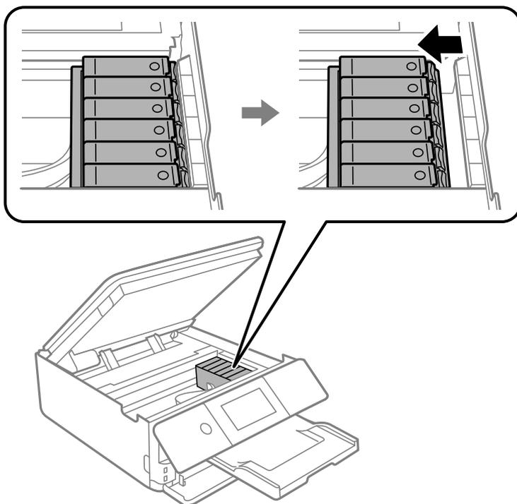
7. ツメを押してインクカートリッジを外し、斜めに引き上げて取り出します。
