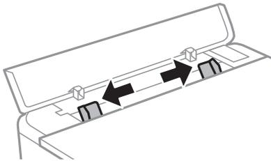
3. 印刷する面を手前にして、手差し給紙の中央の矢印マークに合わせてセットします。
