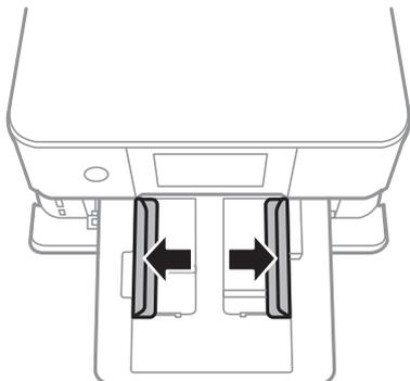
5. 印刷する面を下にして、図の矢印の向きで、上トレイの奥に突き当ててセットします。
