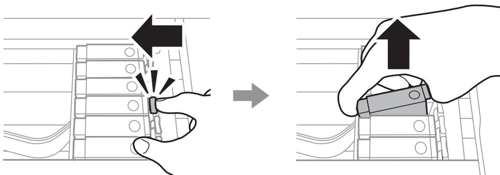
8. 新しいインクカートリッジを先端側から斜めに挿入し、[押]の部分をゆっくり押しします。正しく挿入されると「カチッ」と音がします。
