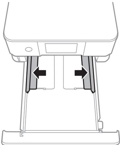
5. 印刷する面を下にして、図の矢印の向きで、下トレイの奥に突き当ててセットします。
