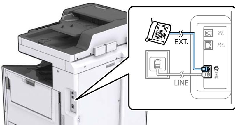
**参考** 1つの電話回線で、ファクスと電話の両方を使用するときは、必ず外付け電話機をプリンターのEXT.ポートに接続してください。同回線にプリンターと並列で接続すると（ブランチ接続）、プリンターも電話機も正常な動作ができなくなります。
