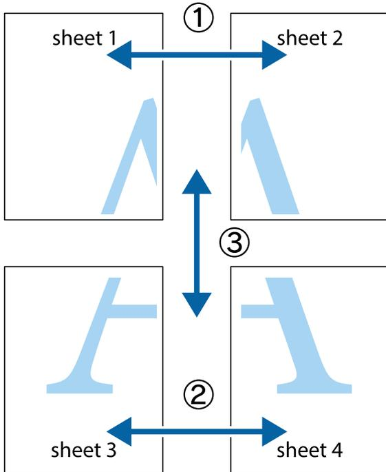
1. Sheet 1とSheet 2を用意します。Sheet 1を、×印と交わっている縦線（青色）を結ぶ線で切ります。
