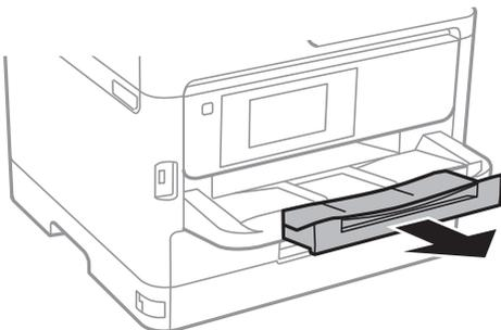
**参考** 印刷用紙の残りはパッケージに入れて保管してください。プリンターにセットしたまま放置すると、反りや品質低下の原因になります。
