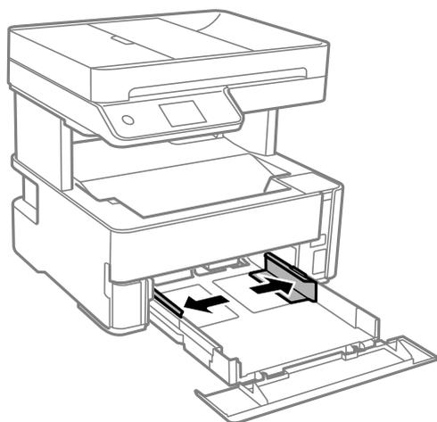
4. 印刷する面を下にして、用紙カセットの奥に突き当ててセットします。
