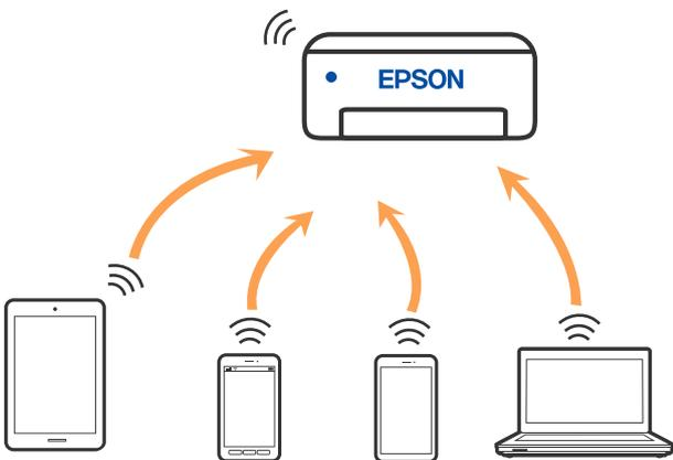
プリンターは無線LAN（Wi-Fi）または有線LANと、Wi-Fi Direct（Simple AP）の同時接続ができます。ただし、無線LAN（Wi-Fi）で接続中にWi-Fi Direct（Simple AP）設定を開始すると、無線LAN（Wi-Fi）接続は一時切断されます。
