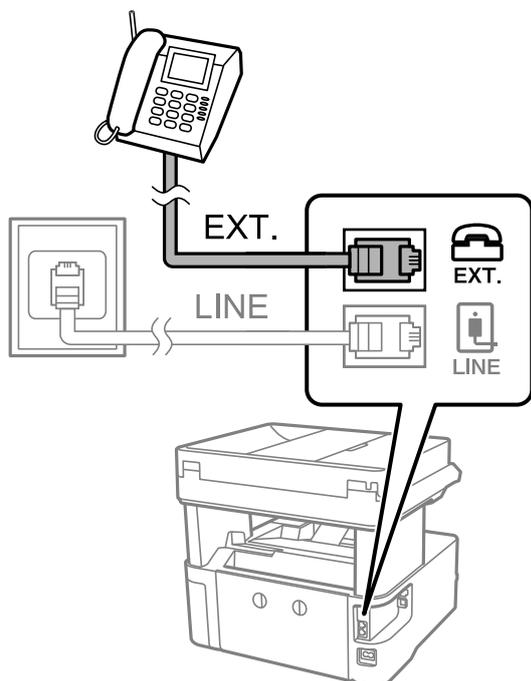
**参考** 1つの電話回線で、ファクスと電話の両方を使用するときは、必ず外付け電話機をプリンターのEXT.ポートに接続してください。同回線にプリンターと並列で接続すると（ブランチ接続）、プリンターも電話機も正常な動作ができなくなります。
