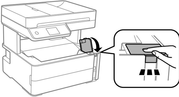
9. ふたの開け口を手前にして、付属のアクセサリボックスを下図のように差し込みます。
