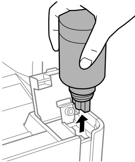
**！重要** ボトルをタンクに挿したままにしないでください。ボトルの破損やインク漏れの原因になることがあります。
