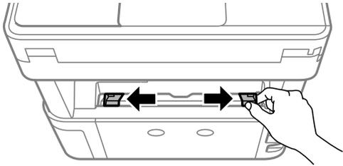
2. 印刷する面を手前にして、手差し給紙の中央にセットします。
