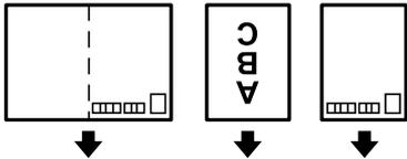
用紙カセットにセットするときは、印刷する面を下にしてセットし、用紙ガイドをハガキに合わせてください。
