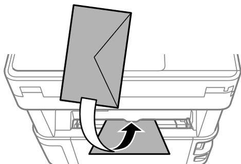
用紙カセットにセットするときは、印刷する面を下にしてセットし、用紙ガイドを封筒に合わせてください。
