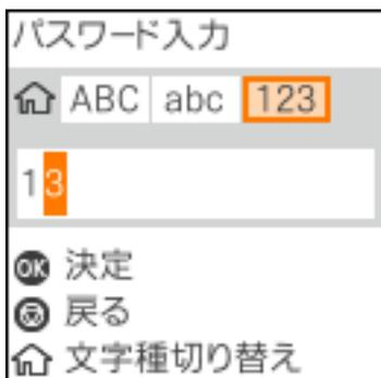
4. ▶ボタンを1回押してカーソルを移動させ、🏠ボタンを押して [ABC] を選択します。さらに▲ボタンを2回押して「B」を選択します。
