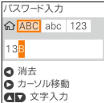
5. ▶ボタンを1回押してカーソルを移動させ、🏠ボタンを押して [abc] を選択します。さらに▼ボタンを2回押して「y」を選択します。
