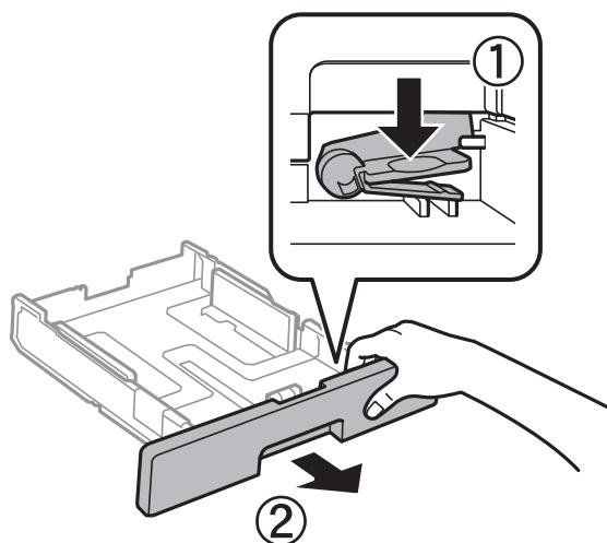
3. 印刷する面を下にしてセットして、手前の用紙ガイドを用紙に合わせます。
