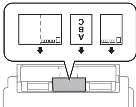
用紙力セットにセットするときは、印刷する面を下にしてセットし、用紙ガイドをハガキに合わせてください。
