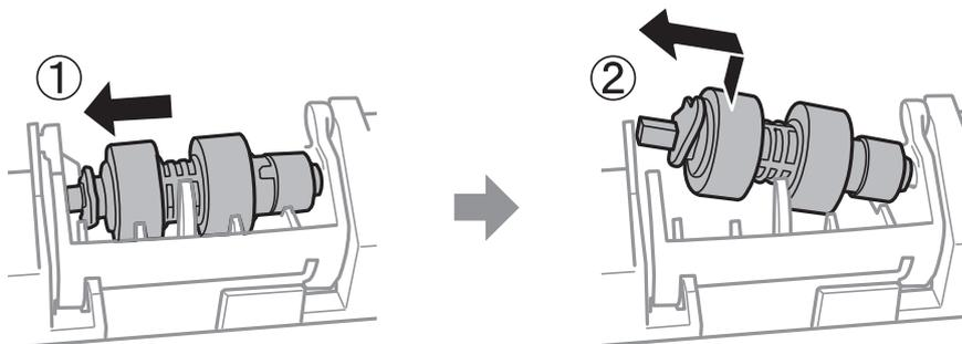
14. 新しい給紙ローラーの軸をホルダーの穴に差し込みます。レバー側の軸は、平らな面を手前に向けて溝に差し込んでください。
