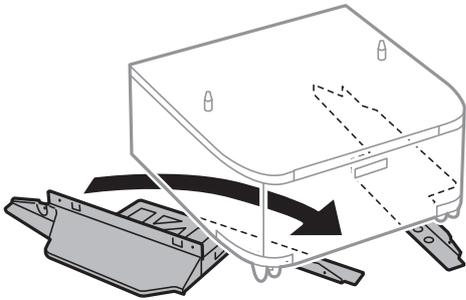
7. 転倒防止脚を固定金具とネジで取り付けます。
