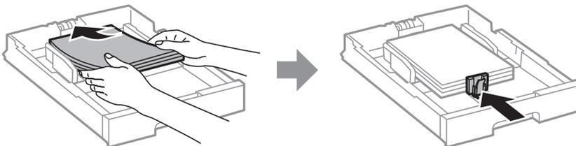
**！重要** 印刷用紙はセット可能枚数を超えてセットしないでください。普通紙は用紙ガイドの三角マークが示す線を越えてセットしないでください。
