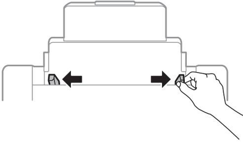
3. 印刷する面を手前にして、背面MPトレイの中央にセットします。
