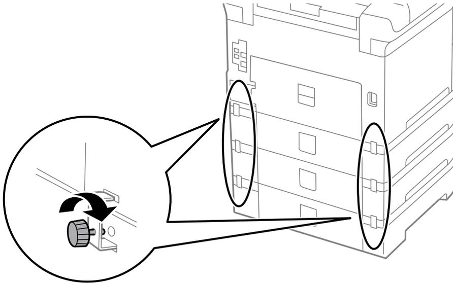
11. 増設カセットユニットにセットする用紙サイズ用の用紙サイズラベルをホルダーに差し込みます。
