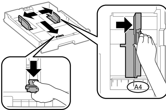
3. 印刷する面を下にしてセットして、手前の用紙ガイドを用紙に合わせます。
