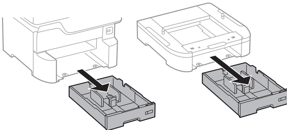
8. 複数の増設カセットユニットを使用する場合は、増設する全てのカセットユニットを重ねて、ネジで固定します。
