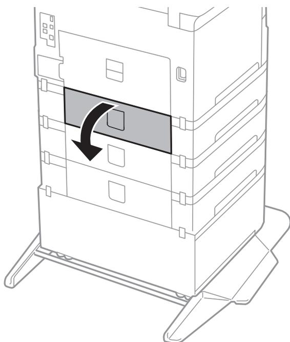
5. ドライバーでネジを取り外し、背面内部にあるカバーを取り外します。
