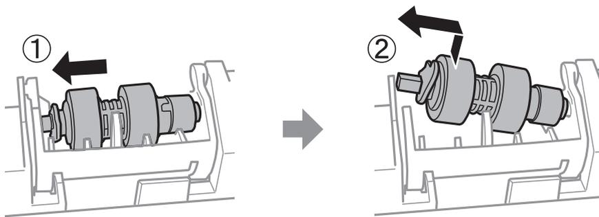
12. 新しい給紙ローラーの軸をホルダーの穴に差し込みます。レバー側の軸は、平らな面を手前に向けて溝に差し込んでください。
