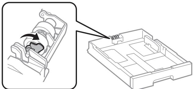
11. 給紙ローラーをレバー側にスライドさせて、軸をホルダーから抜きながら取り外します。
