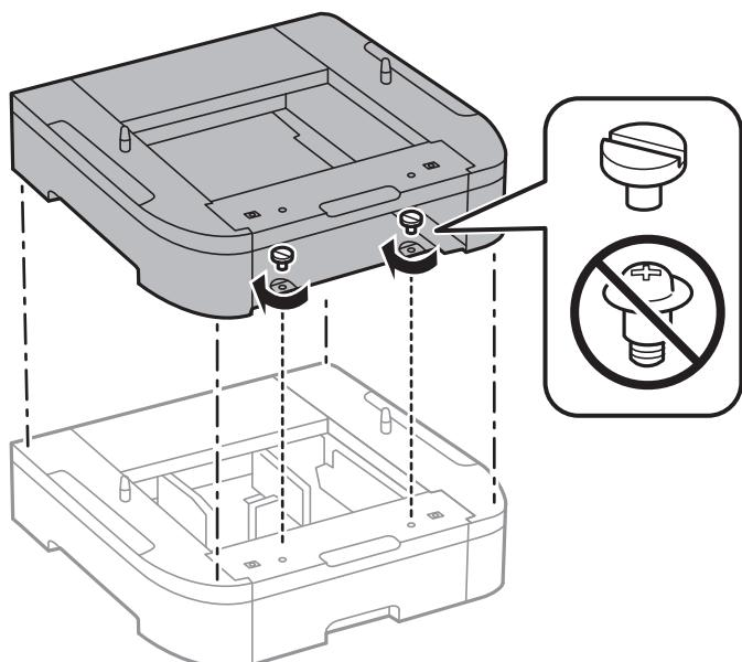
9. プリンターを、増設カセットユニットの四隅と合わせながらゆっくり下ろして置き、ネジで固定します。
