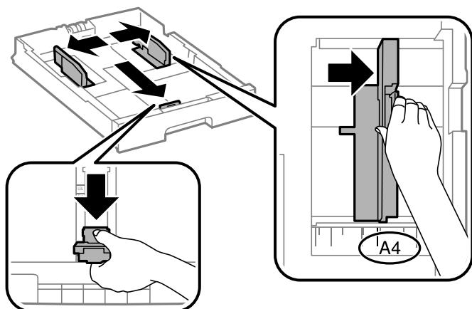
3. 印刷する面を下にしてセットして、手前の用紙ガイドを用紙に合わせます。
