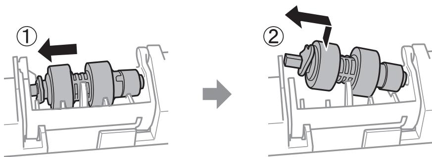
14. 新しい給紙ローラーの軸をホルダーの穴に差し込みます。レバー側の軸は、平らな面を手前に向けて溝に差し込んでください。
