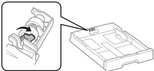
13. 給紙ローラーをレバー側にスライドさせて、軸をホルダーから抜きながら取り外します。
