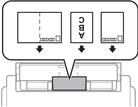
用紙カセットにセットするときは、印刷する面を下にしてセットし、用紙ガイドをハガキに合わせてください。
