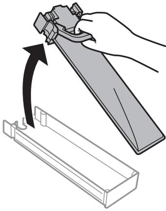
4. 新しいインクパックの箱を手に取り、そのまま水平方向に3秒間（10回程度）、約6cm幅で振ります。
