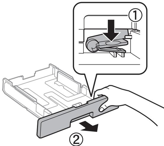
3. 印刷する面を下にしてセットして、手前の用紙ガイドを用紙に合わせてます。
