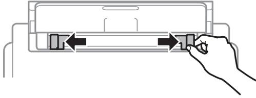
3. 印刷する面を手前にして、背面MPトレイの中央にセットします。
