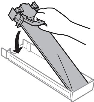
**参考** インクパックを落とすなどして大きく変形した場合は、形状を整えてからセットしてください。変形したままだと正しくセットできず、インク残量が正常に表示されないことがあります。
