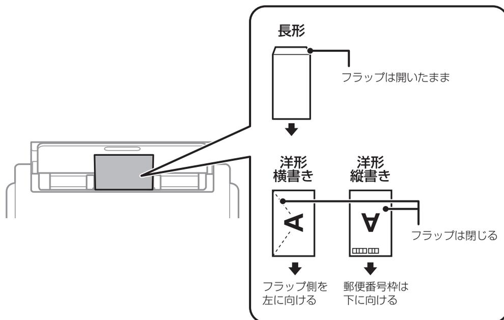
用紙カセットにセットするときは、印刷する面を下にしてセットし、用紙ガイドを封筒に合わせてください。
