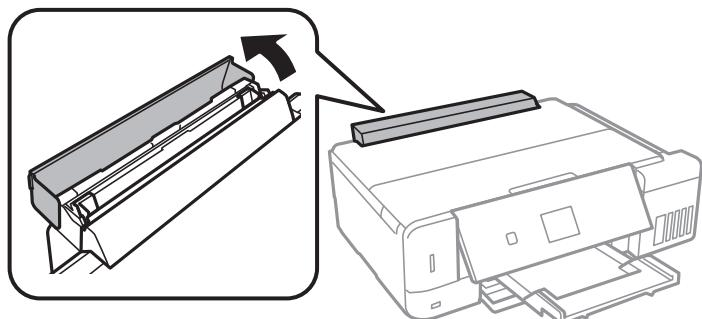
2. 用紙サポートを引き出して、後ろに倒して固定します。
