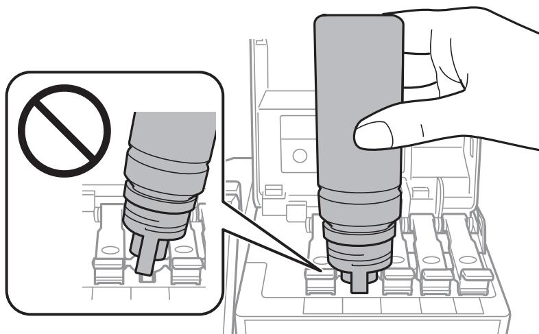
**参考** ボトル先端をタンクのインク注入口に挿してもインクの注入が始まらないときは、ボトルを抜き差してみてください。
