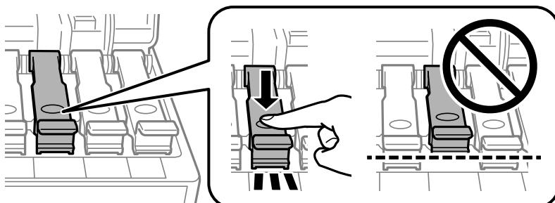
**!重要** ボトルをタンクに挿したままにしないでください。ボトルの破損やインク漏れの原因になることがあります。
