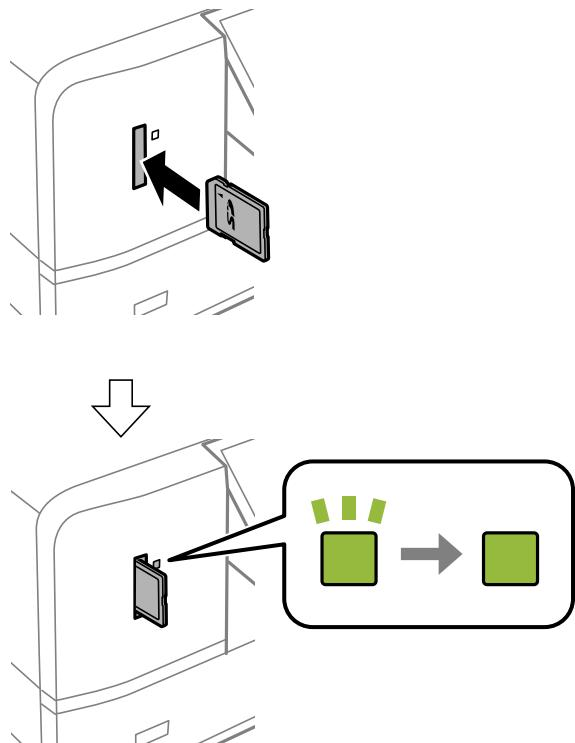
2. 印刷などが終わったら、ランプが点滅していないことを確認して、メモリーカードを取り出します。
