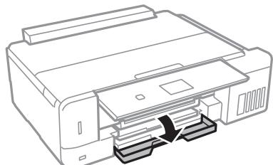
4. プリンターが動作していないことを確認して、上トレイを引き抜きます。上トレイには目印▶が付いています。
