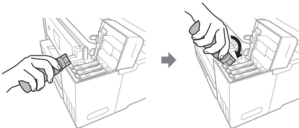
**!重要** キャップを外したボトルの先端をぶつけないでください。インクが漏れることができます。
