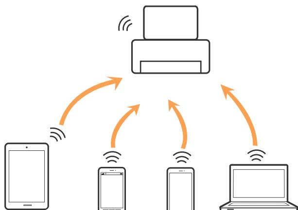
プリンターは無線LAN（Wi-Fi）または有線LANと、Wi-Fi Direct（シンプルAP）の同時接続ができます。ただし、無線LAN（Wi-Fi）で接続中にWi-Fi Direct（シンプルAP）設定を開始すると、無線LAN（Wi-Fi）接続は一時切断されます。
