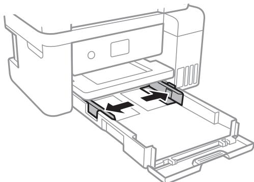
4. 印刷する面を下にして、用紙カセットの奥に突き当ててセットします。
