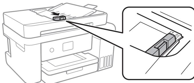
4. スキャンする面を上にしてセットし、ADF原稿ガイドを原稿の側面に合わせます。
