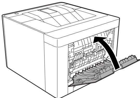
5 天面のボタンを押してカバーF1を開閉し、カバーF2を閉めます。
